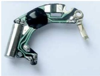
Figure 1 - Circuit imprimé d'une montre bracelet
