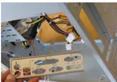
La plaque métallique où se trouvent les ouvertures à l'arrière du PC pour les connecteurs vers l'extérieur (USB, port parallèle, connecteurs réseau, joystick etc.) ne correspond probablement pas à la disposition des connecteurs de votre carte mère. Une plaquette métallique de remplacement accompagne sûrement votre carte mère. Procédez à l'échange de ces plaquettes.
