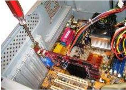
Retirer les équerres métalliques aux emplacements des cartes à installer.
